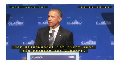
Der Inserter kann auf einem Kanal Untertitel, AFD-Status und Zeitcode aus den Eingängen zur Überwachung oder Weiterverbreitung graphisch einblenden.
